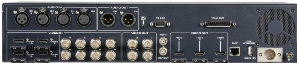
Панель интерфейсов основного блока
