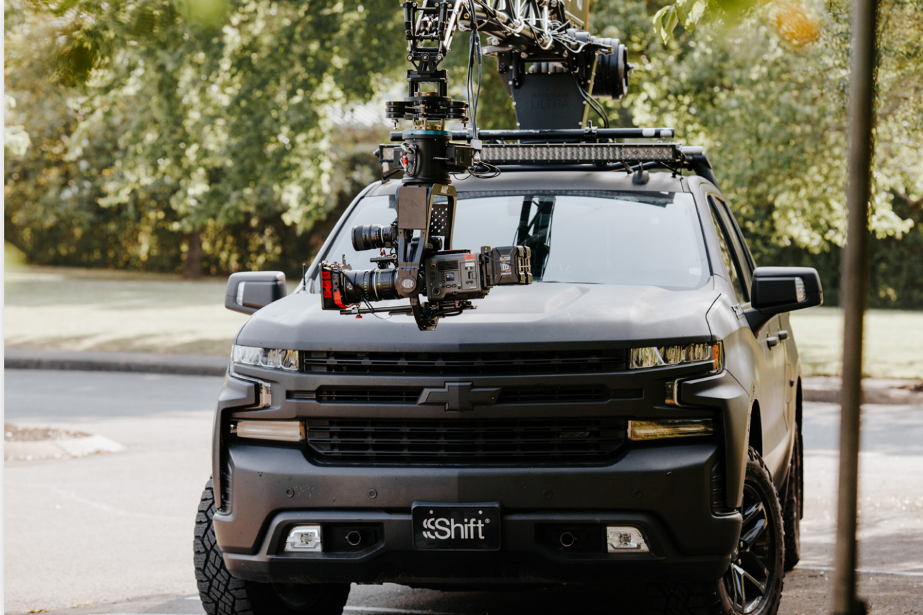
Камера с вариообъективом Leitz на операторском кране, закрепленном на автомобиле
