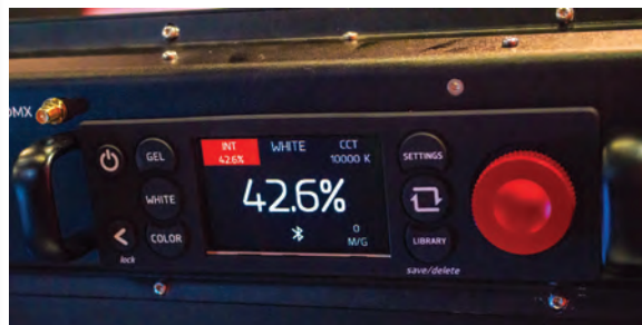
Контроллер на балласте прибора MIX
