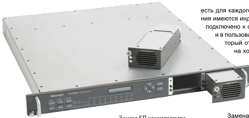
Замена БП коммутатора проводится в горячем режиме со стороны передней панели
