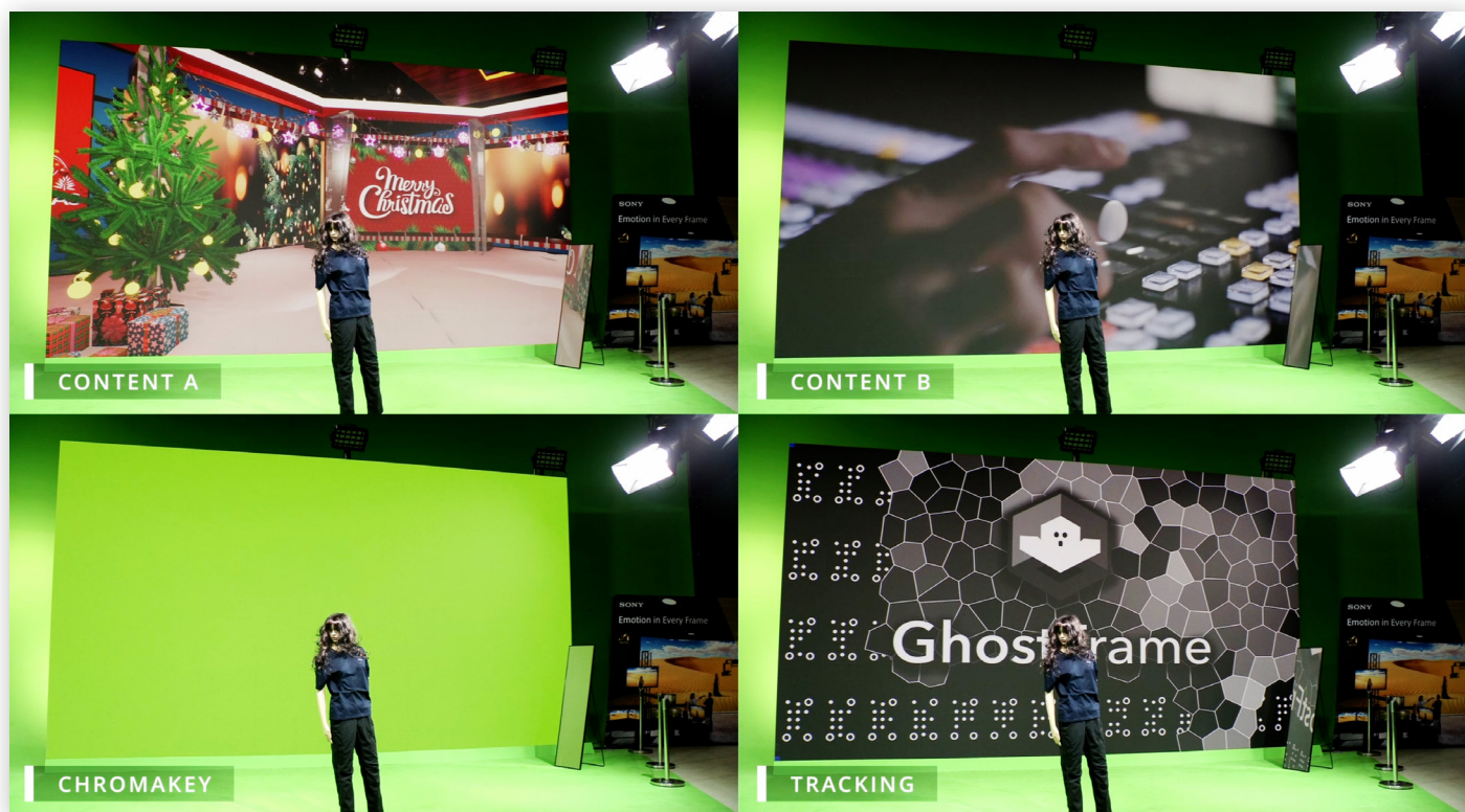
Четыре сигнала, одновременно формируемых камерой Sony HDC-5500 в составе системы GhostFrame
