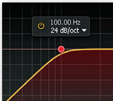
Включение в Side Chain компрессора фильтра нижних частот
