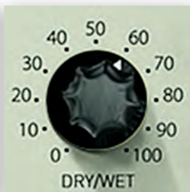
Варианты регулировки баланса обработанного и необработанного сигналов
