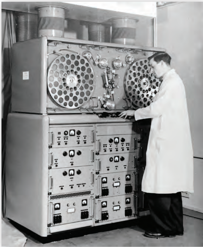
Рис. 4. Vision Electronic Recording Apparatus, созданный в Би-би-си
