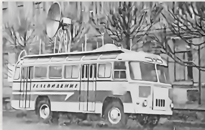
Автобус ПАЗ-652М, оснащенный для несения приемных антенн
