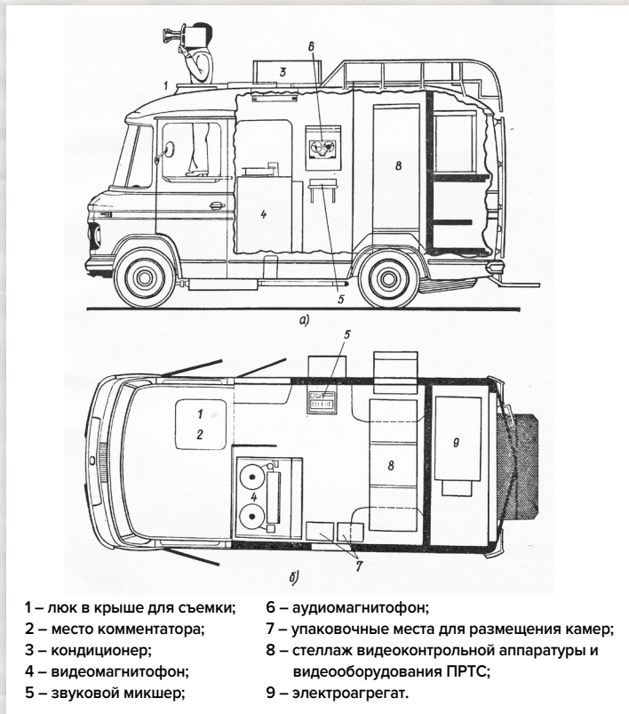
Размещение оборудования в легкой репортажной станции. а – вид сбоку, б – вид сверху.
