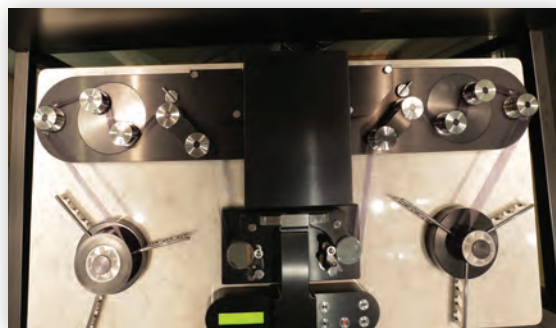
Фильм-сканер для оцифровки изображения с кинопленки
