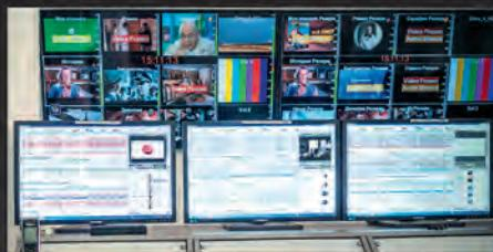
Надежное многоканальное решение в одном системном блоке: запись, автоматический файловый импорт и воспроизведение, live-трансляции, графика, DVE, оформление каналов, импорт/верстка play-листов, прием и генерация меток SCTE/DTMF, up/down/cross конвертация, 100% резервирование, "врезка" рекламы, телетекст, субтитры. Форматы: SDI/HDMI/IP/ASI, Ultra HD HDR PQ/HLG/HD/SD.
