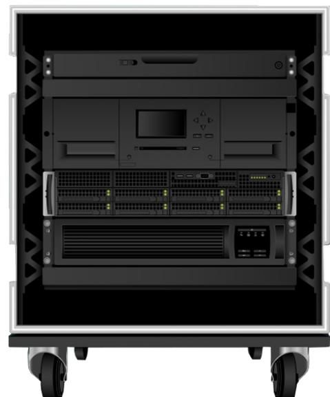
FUJIFILM Kangaroo помогает снизить уязвимость к хакерским и кибератакам за счет возможностей защиты, свойственных ленточным носителям, включая более высокую, чем обеспечивают жесткие диски, целостность данных, полную изоляцию от информационных сетей и срок архивного хранения не менее 30 лет.
