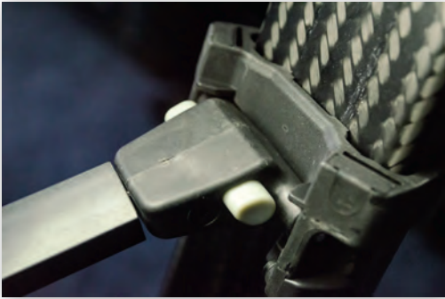
Центральный шарнир растяжки и замок крепления ее к ножке
