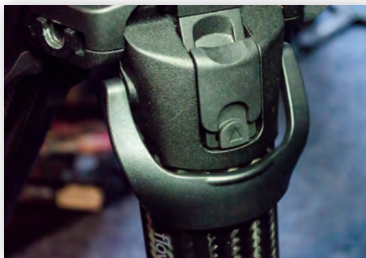
Замок ножек: скоба служит для регулировки длины, а кнопки внутри нее – для изменения угла раскрытия ножек
