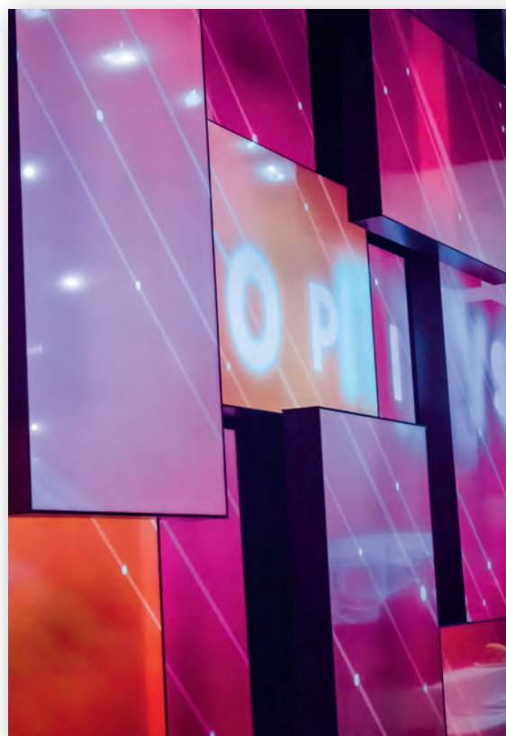
Два примера видеостен – простая 2x2 и сложная, где отдельные дисплеи даже находятся в разных плоскостях
