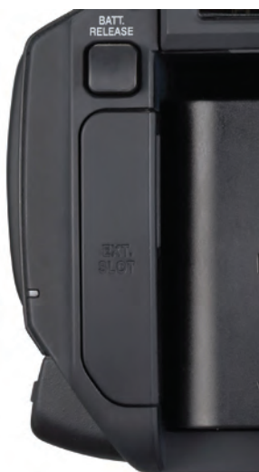
Слот расширения, в который с помощью опционального адаптера устанавливается носитель SSD
