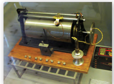
Рис. 4. Телеграфон, созданный Вальдемаром Польсеном
