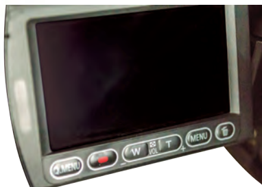
Дублирующая кнопка записи на откидном дисплее
