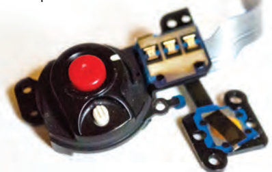
Выключатель питания (он же — селектор режимов) и основная кнопка записи
