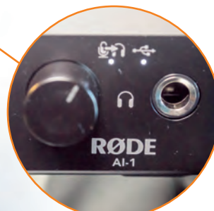
Индикаторы говорят о том, что прибор подключен по USB и выбран режим прямой подачи сигнала в наушники
