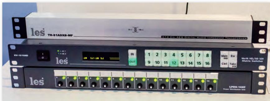
Оборудование компании «ЛЭС-ТВ» (сверху вниз): адаптер TR-81ADXB-MF, матричный коммутатор KV-1616HD и распределитель питания LPDU-14XF
