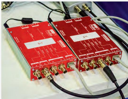
Двунаправленные инкапсуляторы ProBox PBX-ENP-200
