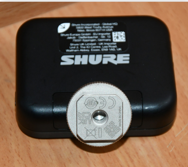
Узел крепления приемника на башмак камеры
