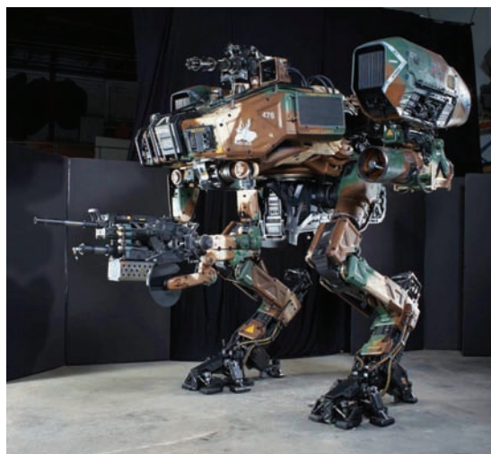
Макет робота, отпечатанный на 3D-принтере
