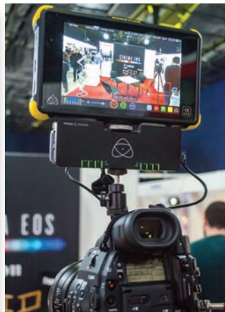
Рекордер Atomos Shogun Flame, установленный на камере Canon C300 Mark II
