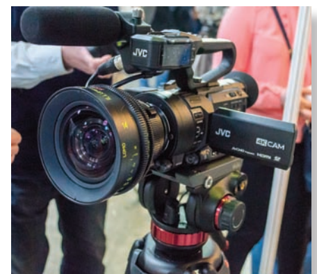
14-мм объектив ILLUMINA S35 на 4K-камере JVC GY-LS300CHE
