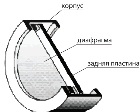
Конструкция конденсаторного микрофона
