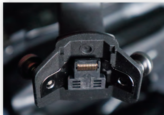
Контактная группа на верхней рукоятке и подвес крепления внешнего микрофона
