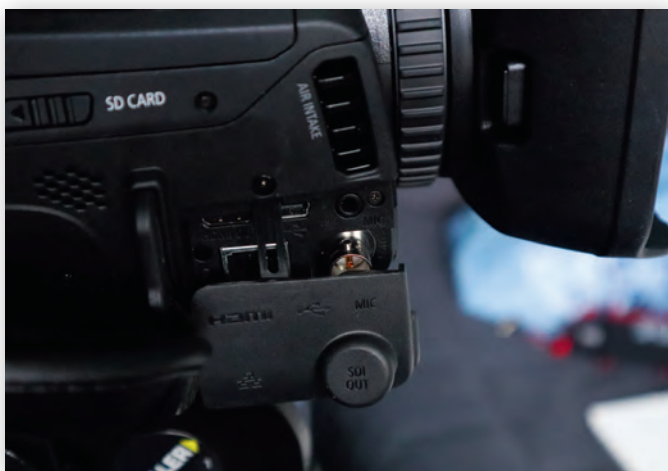
Защитный колпачок интерфейсов камеры
