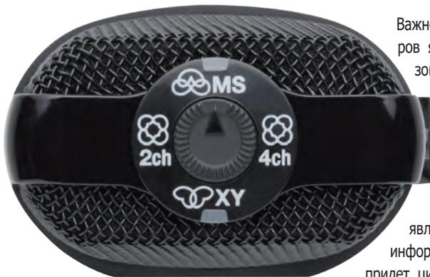
Селектор режимов панорамной записи на аудиорекордере
