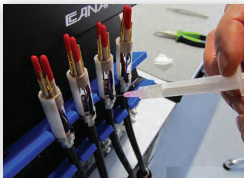
Этапы монтажа разъемов на гибридные кабели в лаборатории ПО «Перспектива»
