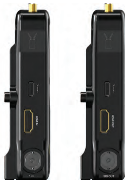
Интерфейсы передатчика (слева) и приемника
