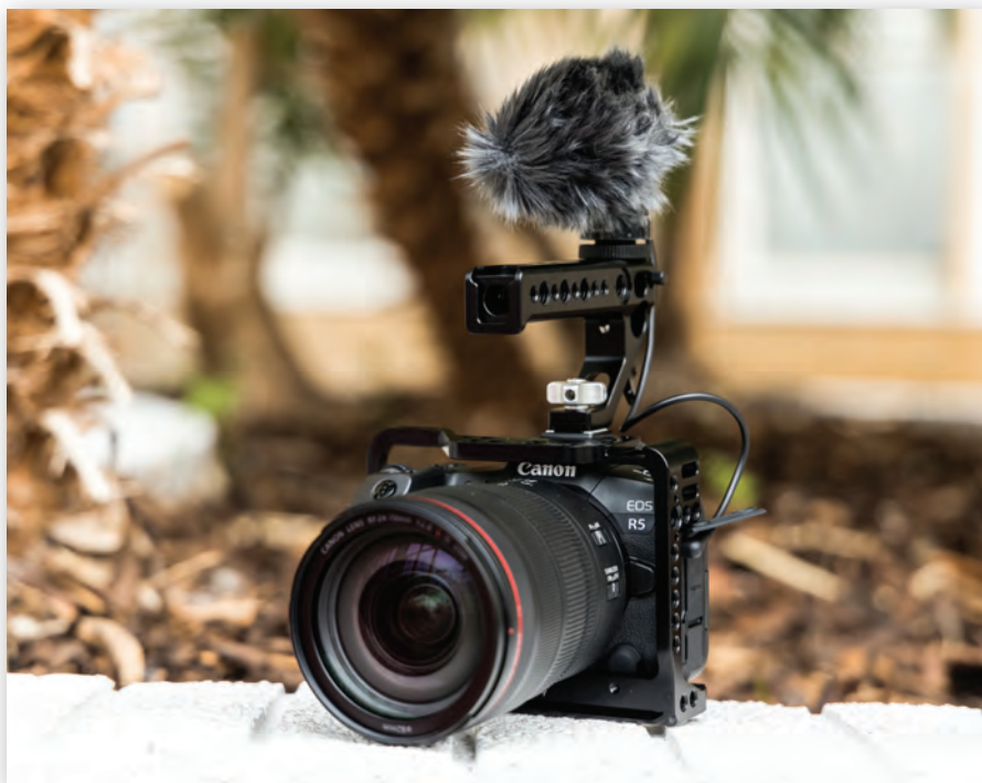
EOS R5, оснащенная микрофоном и установленная на платформе для видеосъемки с рук
