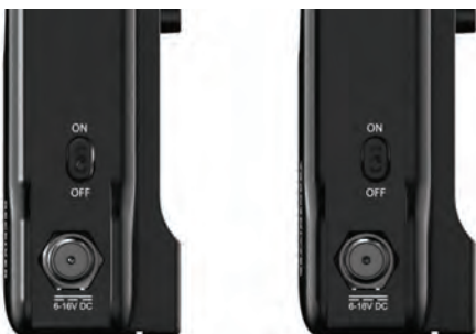
Кнопка включения и разъем подачи питания
