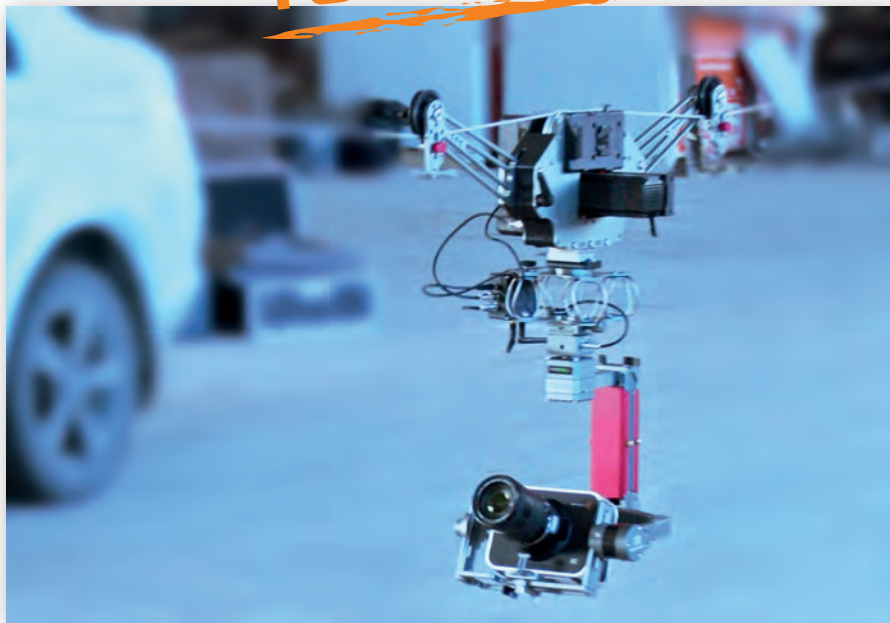
Тросовая моторизованная система CableCam Fly20 RCx со стабилизатором iStab 5PRO RCx
