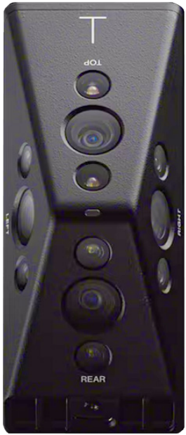
Расположение объективов на верхних гранях сенсорного блока
