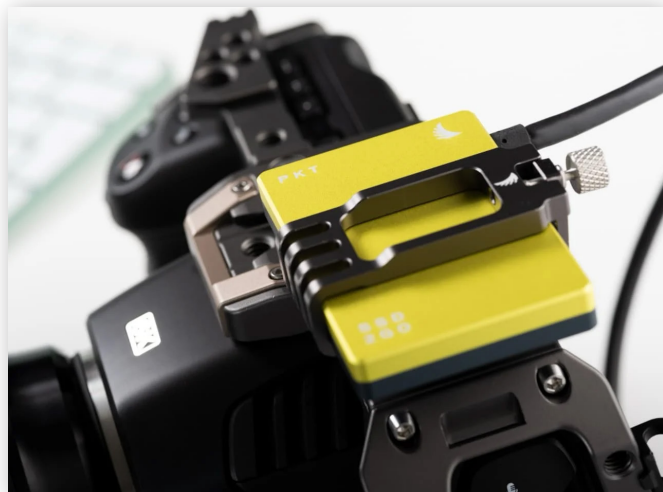
Крепление носителя на камеру с помощью специального узла
