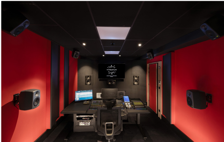
Одна из новых студий Titrafilm в Париже для микширования звука Dolby Atmos, оснащенная мониторами Genelec 1032C для LCR и моделями 8340A для каналов объемного звука
