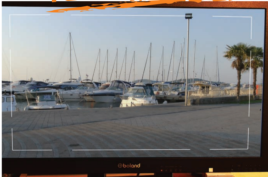
Отображение входного сигнала с выводом маркеров
