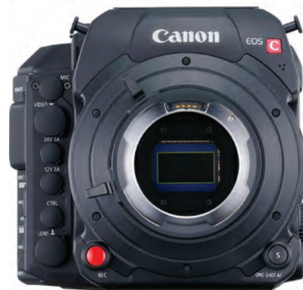
Камера с байонетом PL – хорошо виден сенсор формата Super 35mm
