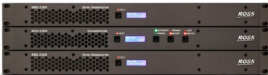
Система формирования опорного сигнала на основе двух генераторов SRG-2200 и коммутатора ACO-2200 (в центре)
