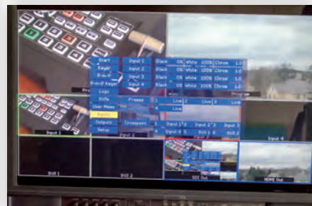
Рукоятка T-Bar и клавиши управления микшером (вверху) и меню, выводимое на полиэкранный
