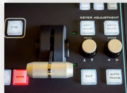
Полиэкран с выведенным на него меню (вверху) и T-Bar и органы навигации по меню (посередине справа)
