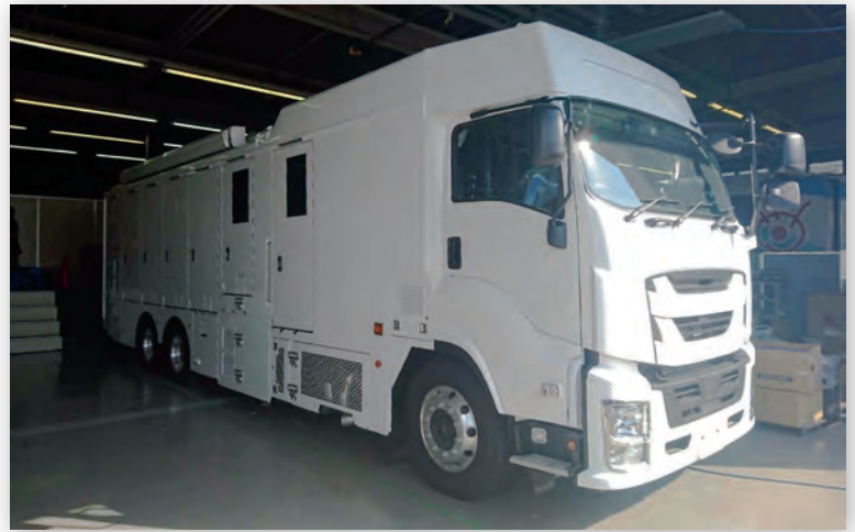
Новейшая ПТС 8K компании NHK, созданная на базе гибридной технологии 12G-SDI/IP
