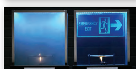
Тест горения кабелей в оболочках PVC (слева) и NG (A)-HF. Время горения, с (сверху вниз): 0, 15, 25, 35, 50
