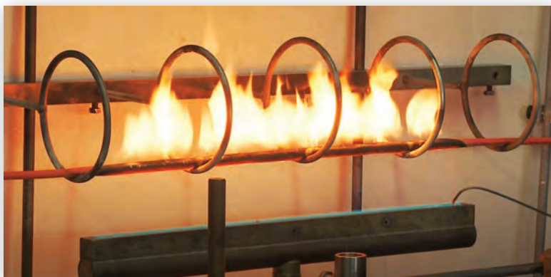
Рис. 2. Испытание кабеля путем воздействия на него открытым пламенем
