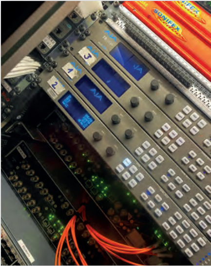
Конвертеры AJA FS-HDR в технологической стойке Studio Berlin
