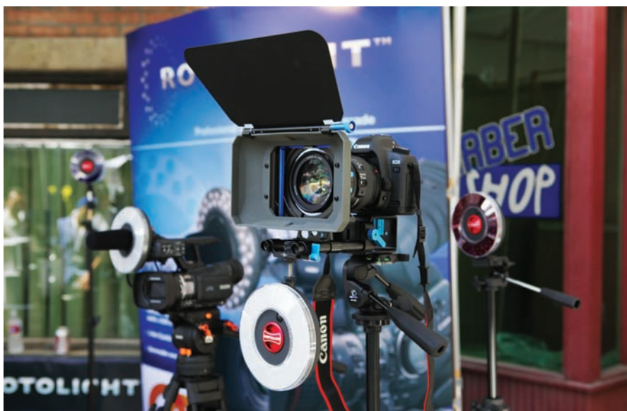
Приборы RL48, установленные на направляющих стержнях и на микрофоне-пушке (на заднем плане)
