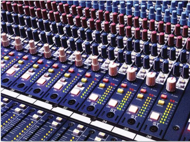
Традиционная аналоговая консоль с колонками регуляторов в каждом канале
