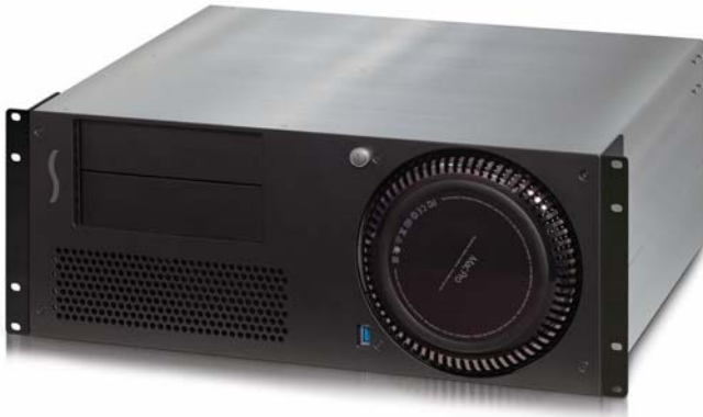
Вещательный сервер на базе xMac Pro и ПО Softron
