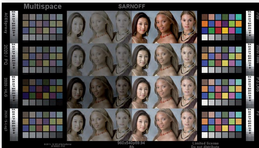
Рис. 11. Таблица Multispace содержит три одинаковых элемента, визуализированных каждый в восьми цветовых пространствах. Та часть, которая выглядит корректно, показывает, как сигнал интерпретируется монитором.
