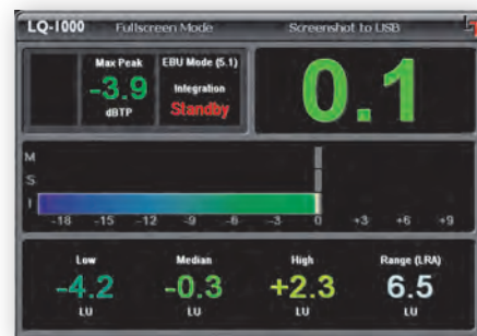
Результаты тестирования модуля PALC-7357 на приборе Linear Acoustic LQ-1000
