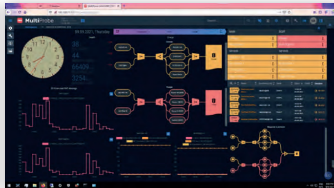
Пример сконфигурированного рабочего стола дежурной смены (непрерывный мониторинг состояний объектов и услуги в целом в виде графа, а также анализ конкретных характеристик сигнала)
