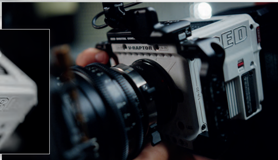
Крепление объектива через байонет RF
