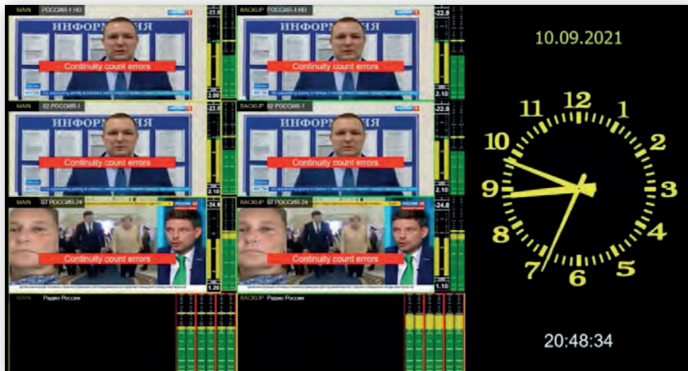
Пример полиэкранной мозаики визуализации в точке контроля (может быть выведена локально на видеостену или отправлена по сети и Интернету)
