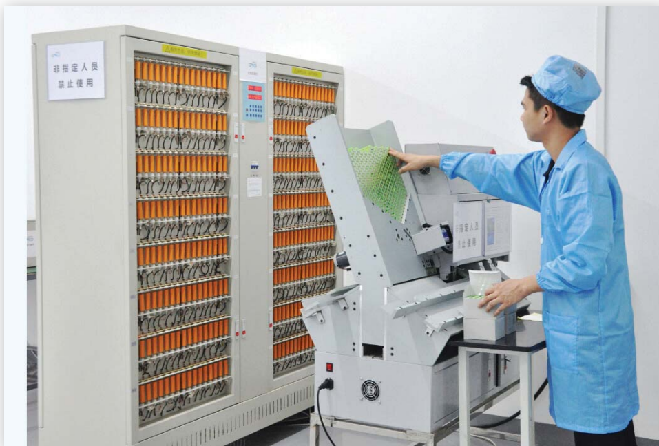
Процесс сортировки ячеек – грейдинг
