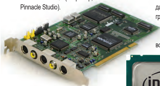
Pinnacle Miro DC30 — одна из культовых плат ввода/вывода конца 1990-х — начала 2000-х
