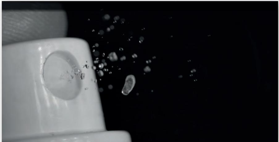
Кадр высокоскоростной съемки – жидкость, вылетающая из сопла пульверизатора: разрешение 1280×800, 38 тыс. кадр/с
