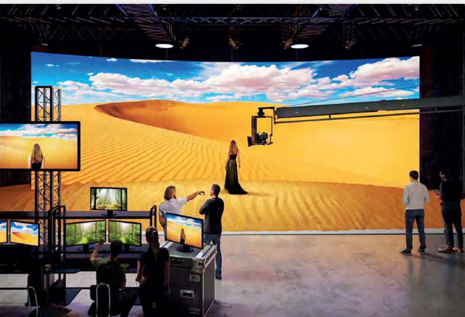
Применение светодиодного экрана Sony Crystal LED на съемочной площадке (фото Engadget)
