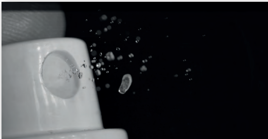
Кадр высокоскоростной съемки – жидкость, вылетающая из сопла пульверизатора: разрешение 1280×800, 38 тыс. кадр/с
