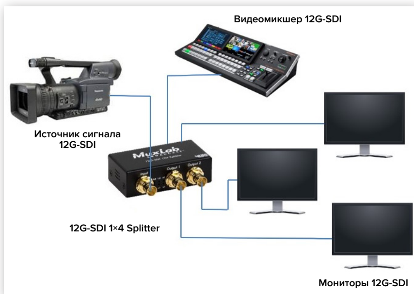
Пример применения 12G-SDI 1×4 Splitter для раздачи одного сигнала от камеры четырем потребителям
