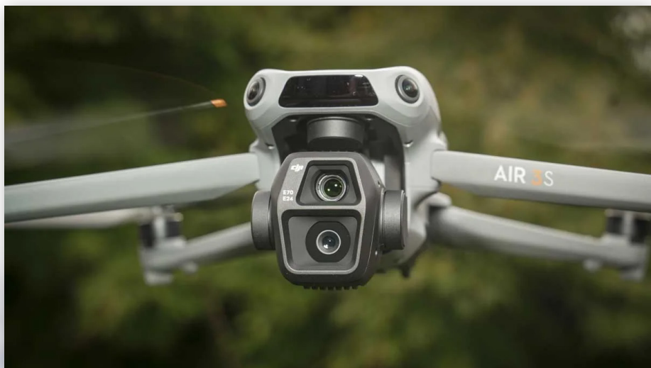
Основная (верхняя) и вспомогательная камеры дрона
