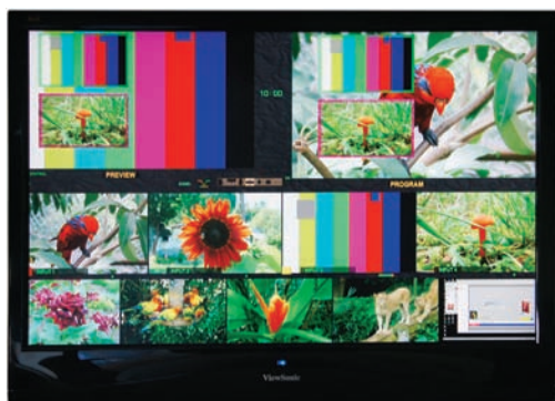
MW9 HDSDI отображает девять сигналов на одном экране
