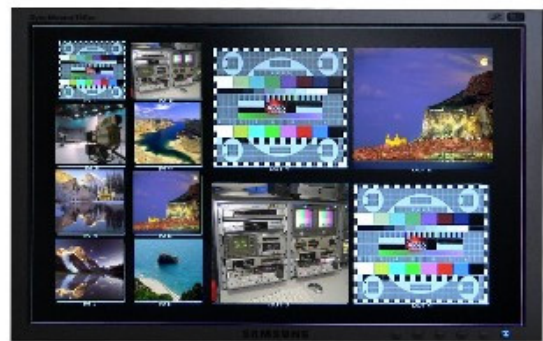
DSC824 показывает на одном цифровом DVI-выходе 12 сигналов
