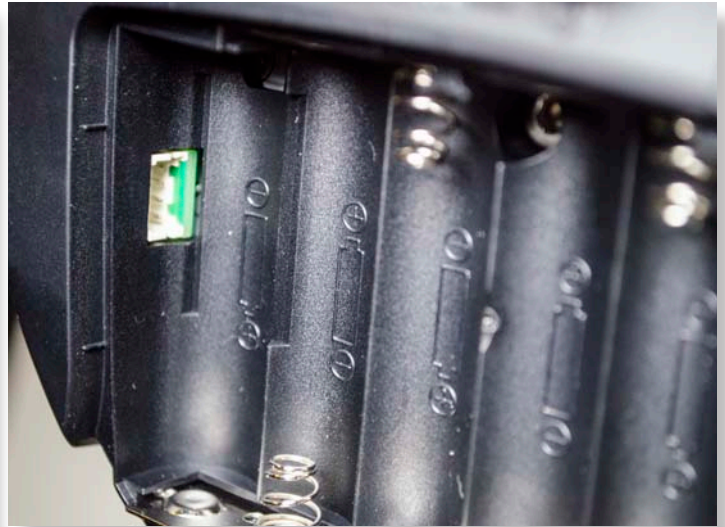
Батарейный отсек. Слева хорошо виден разъем для диагностики и обновления прошивки
